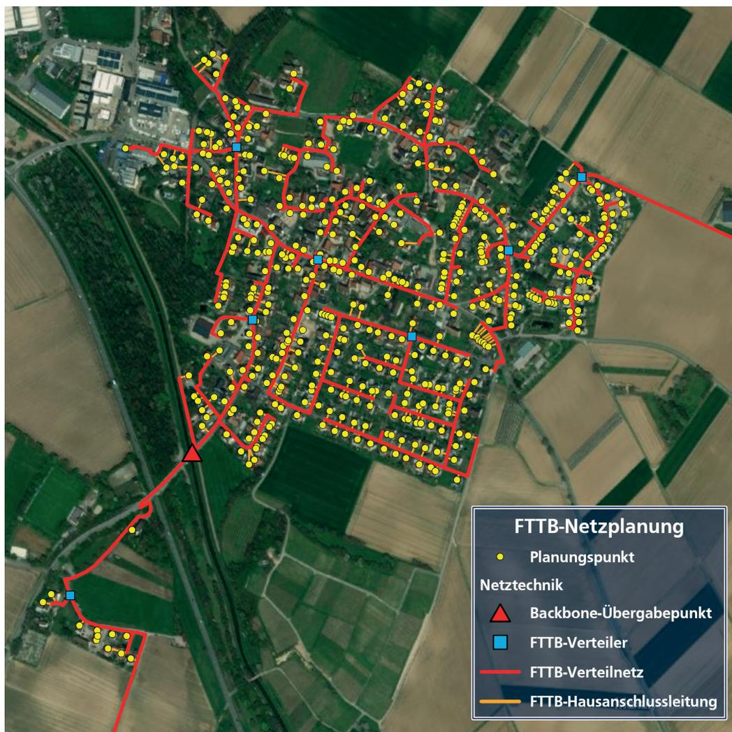
Abbildung 12: Bestandteile der FTTB-Grobnetzplanung in der Detailansicht
